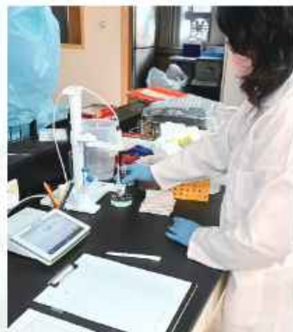
▲量測水樣導電度
